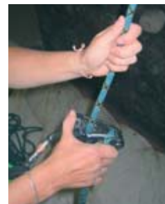
Při jištění GriGri musí brzdicí ruka stále svírat brzdné lano.
