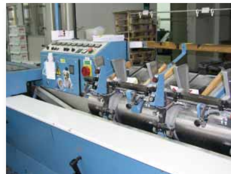
Snášecí linka Wholenberg, kde se řadí jednotlivé složky za sebe a na konci je celý knižní blok pohromadě.
