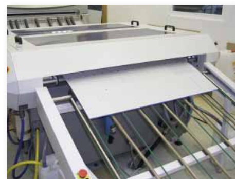
CTP osvitová jednotka Creo Lotem na výrobu tiskových desek. Právě z ní jedná vyjíždí.
