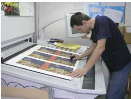
Tiskař musí před rozjetím stroje zkontrolovat barevné podání a soutisk barev na zkušebně zhotovených arších.
