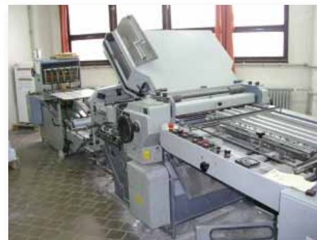
Falcovačka Stahl, na které se nafalcuje archy do jednotlivých složek.
