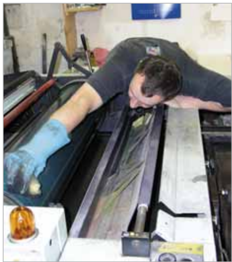
Před tiskem další barvy je potřebné tiskový válec důkladně umýt od předchozí barvy.
