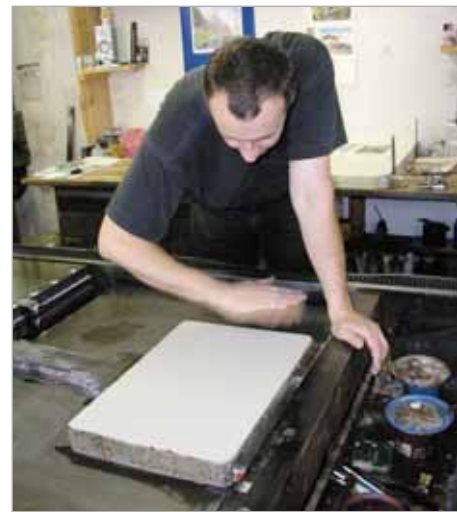
Přebroušený a vyčištěný kámen je připraven pro kreslení další barvy.
