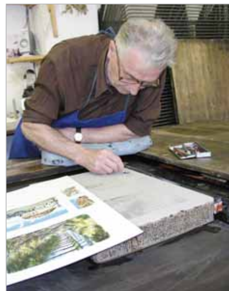
Nastupuje výtvarník a na litografický kámen kreslí speciální křídou nebo tuší kresbu pro další barvu.
