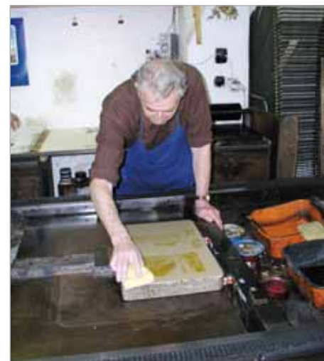
Po každém průchodu se musí litografický kámen otřít vodou.
