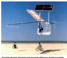
Gossamer Penguin, zmenšená verze Gossamer Albatrossu, apotížený panelem se solárními články.
