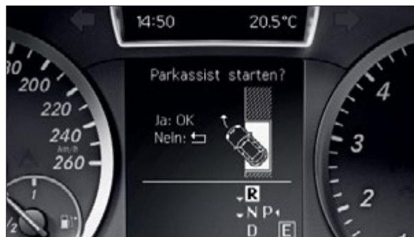
Displej na přístrojové desce poskytuje přehled o aktuálním průběhu parkování.
