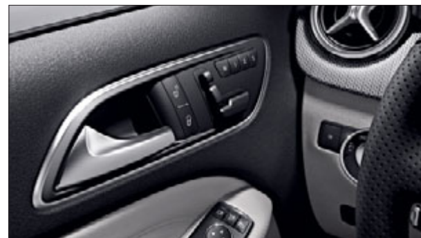
Paměťová sada s plně elektricky nastavitelným sedadlem řidiče si zapamatuje až tři individuální nastavení.
