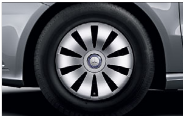
Ocelová kola s ozdobným krytem v designu 10 otvorů, s pneumatikami 195/65 R 15 (standardní výbava pro B 180 CDI BlueEFFICIENCY a B 180 BlueEFFICIENCY), kód R00.
