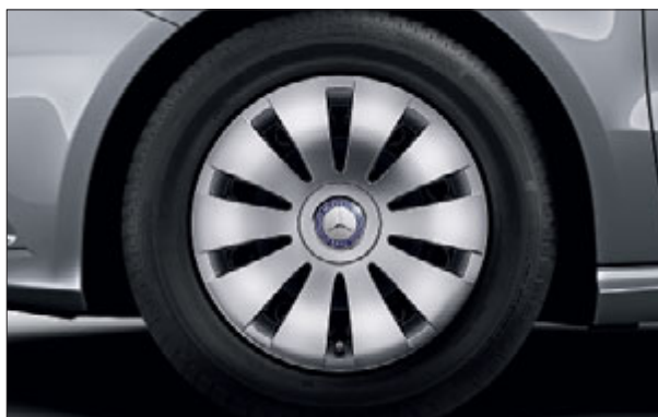
Ocelová kola s ozdobným krytem v designu s 10 otvory s pneumatikami 205/55 R 16 (standardní výbava pro B 200 CDI BlueEFFICIENCY a B 200 BlueEFFICIENCY, nedodávají se pro sady Sport a Night), kód 643.
